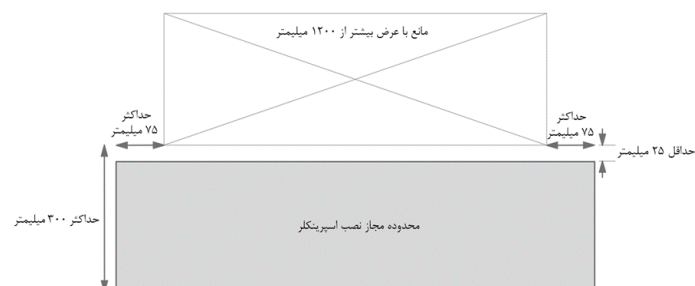
شکل ۲۲-۵-۴- محل نصب اسپرینکلر در زیر موانع عریض
