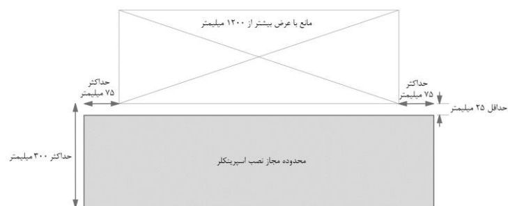
شکل ۴-۶-۲۰- محل نصب اسپرینکلر در زیر موانع عریض
