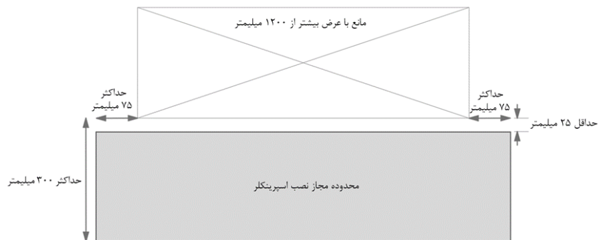
شکل ۴-۷-۲۶- محل نصب اسپرینکلر در زیر موانع عریض
